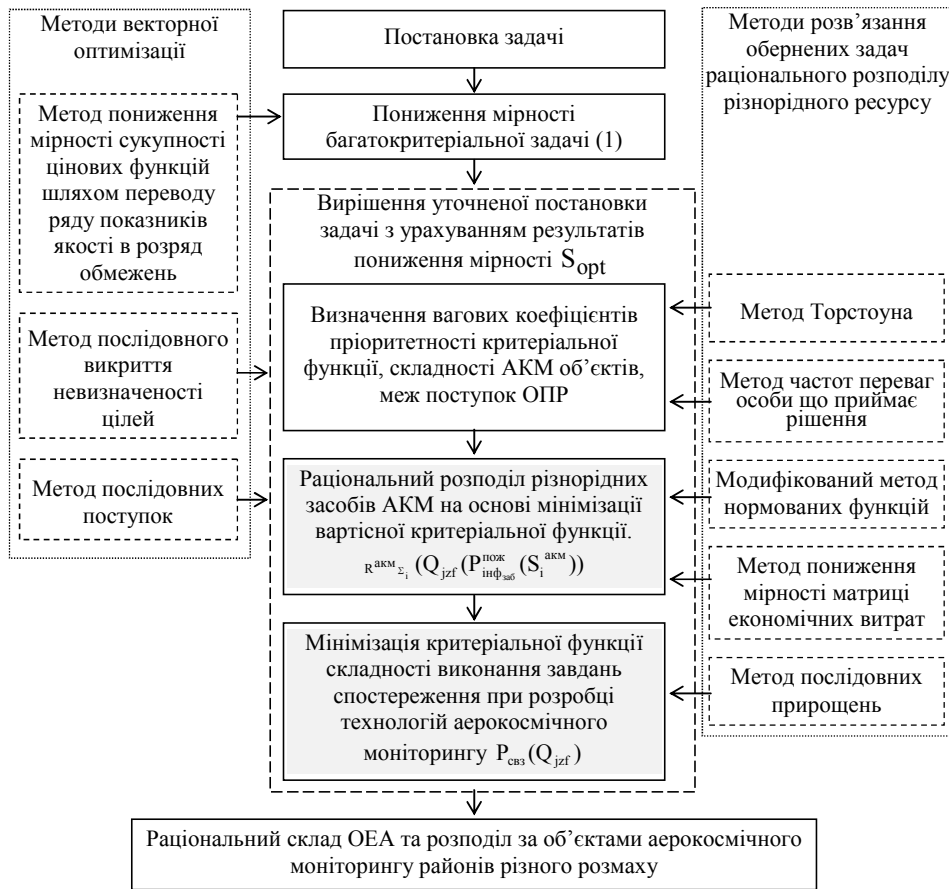
Рисунок 5 – Структурна схема етапу оптимізація розподілу ресурсу оптико-електронної апаратури (ОЕА) за районами (об'єктами) для подальшого обґрунтування технології виконання завдань моніторингу районів різного розмаху
