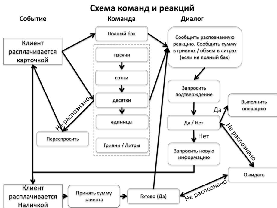
Рисунок – Схема взаимодействия пользователя и терминала
