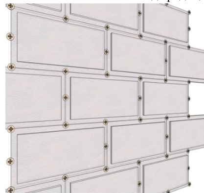
Рисунок 5 – Технологічна схема розташування дюбелів (6 шт/м 2 )
