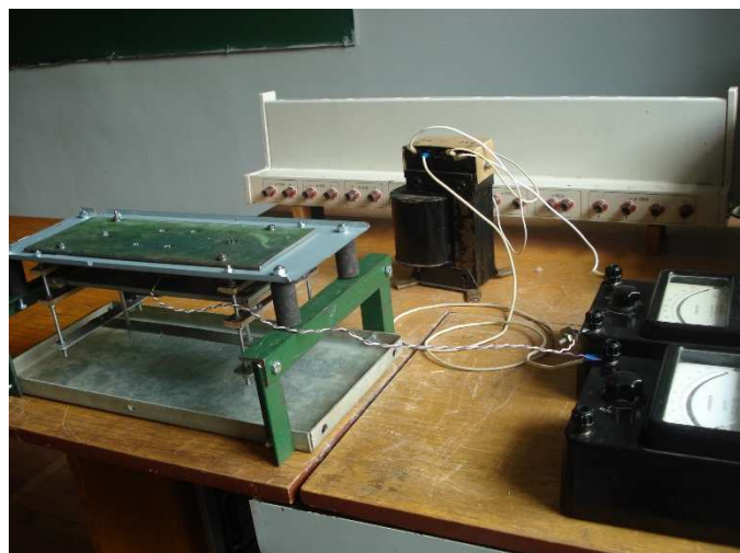
Рисунок 5 – Лабораторна двомасова електромагнітна ударно-вібраційна установка зі зміненою конструкцією підвіски ударника
