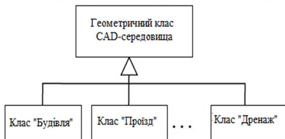
Рисунок 4 – UML-діаграма успадкування класів просторових об'єктів
