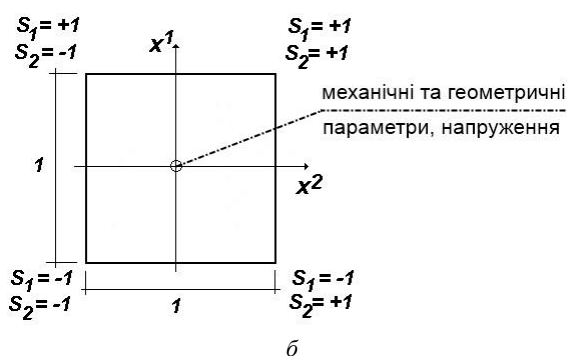
Рисунок 2 – Схеми інтегрування в околі поперечного перерізу СЕ: а – точки інтегрування у площині; б – усереднення значень
