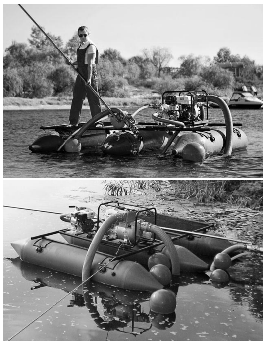
Рисунок 1 – Принципова будова та складові частини мініземснаряду
