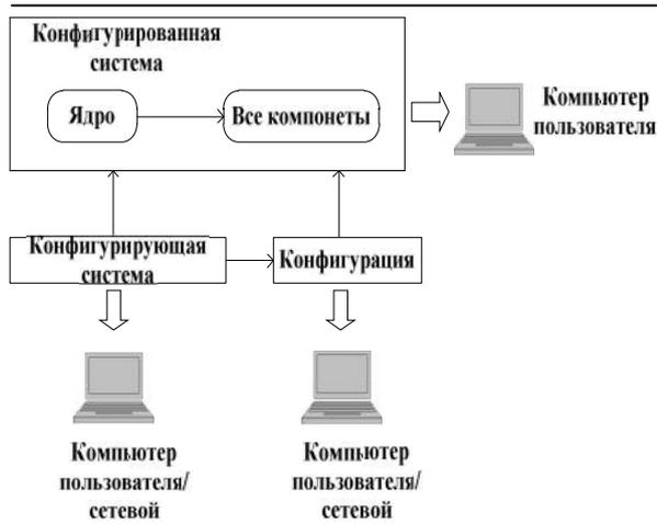
Рис.2. Принципиальная схема реализации первого подхода к разработке конфигуратора
