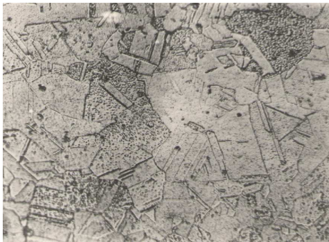
Рисунок 2 – Структури поверхонь зразків: а – після 30 тис. циклів навантажень (x230); б – вихідний стан
