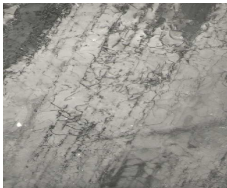
Рисунок 3 – Зміна дислокаційної структури зразків: а – вихідний стан; б – після 30 тис. циклів (x10000)
