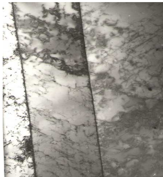
Рисунок 4 – Поява (а) і розвиток (б) деформації за рахунок процесу двійникування (x10000)
