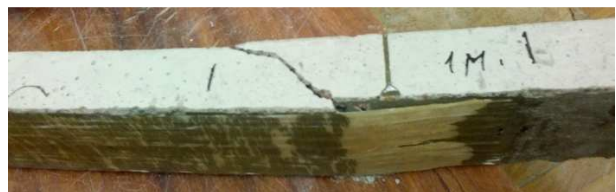
Рисунок 5 – Характер руйнування балки, підсиленої скловолокном (серія №2)
