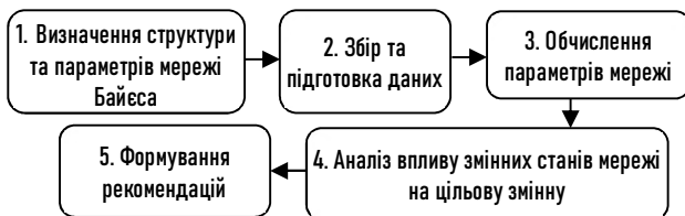
Рисунок 2 – Процес для підтримки прийняття рішення щодо визначення кількості розділів на Apache Kafka-топіку
