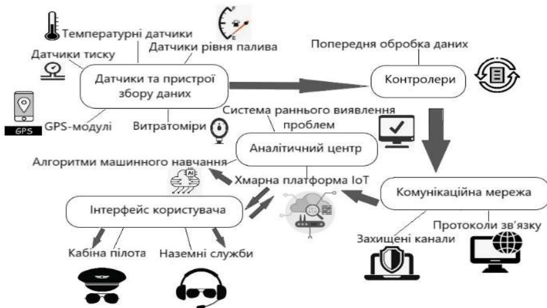
Рисунок 2 – Модель IoT-системи для оптимізації паливного комплексу літака
